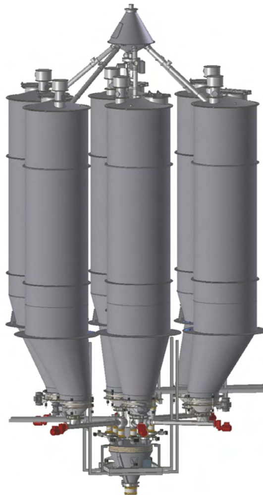
Bild 8: Silobefüllung über Drehrohrverteiler (AZO GmbH + Co. KG)
