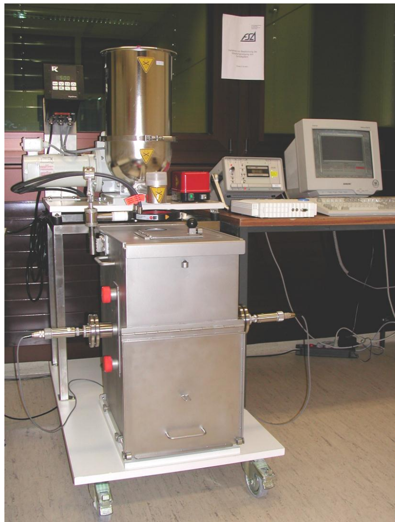
Abbildung 1: Apparatur zur Bestimmung der Staubungsneigung von Schüttgütern. Links und rechts an der Messkammer (Stahlbehälter) sind der IR-Sender und -Empfänger des SKG 5 zu sehen.
