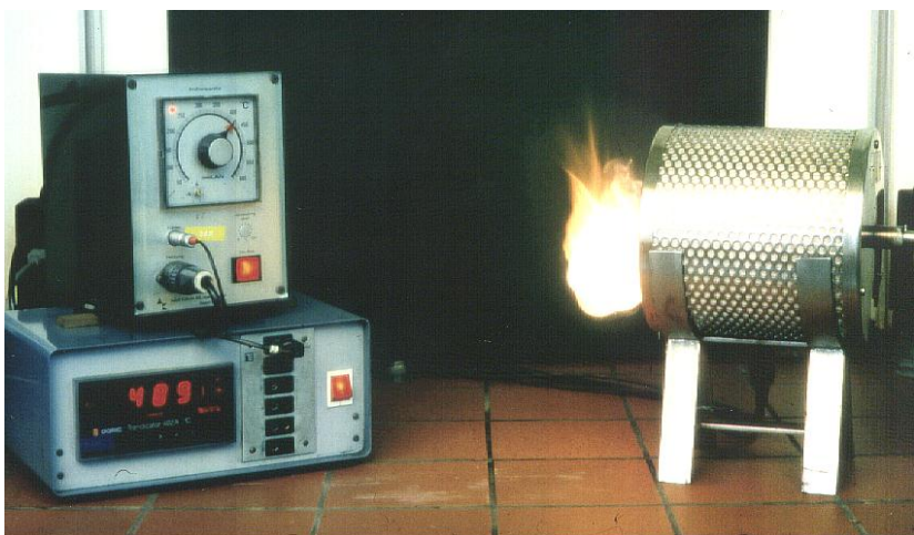
Abbildung 4: Laborapparatur zur Bestimmung der Zündtemperatur aufgewirbelter Stäube.
