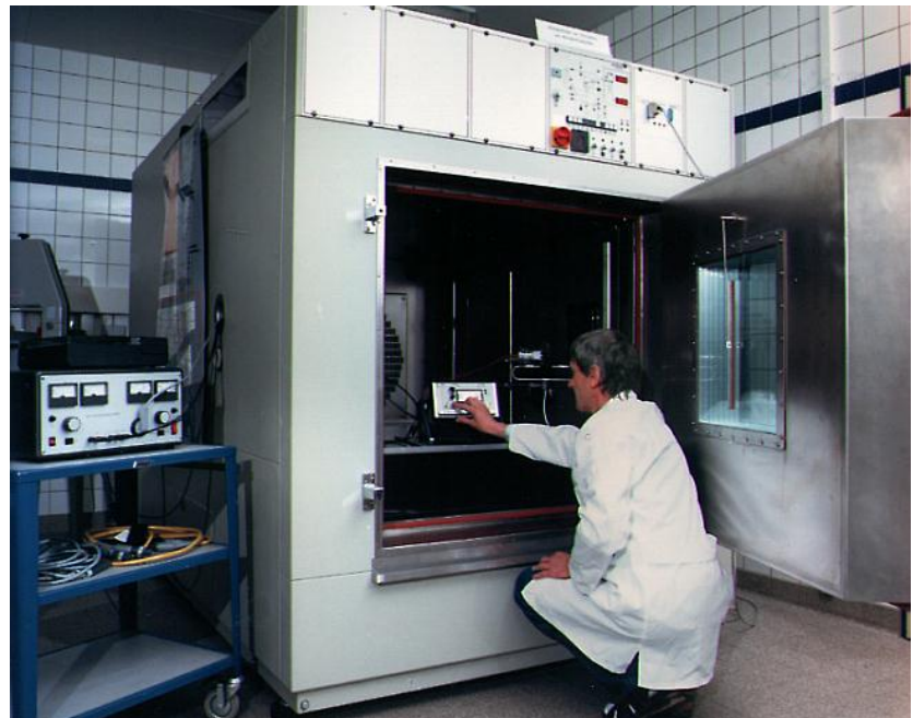
Abbildung 6: Untersuchung des Klimaeinflusses auf elektronische Baugruppen im Labor für Klimasimulation.
