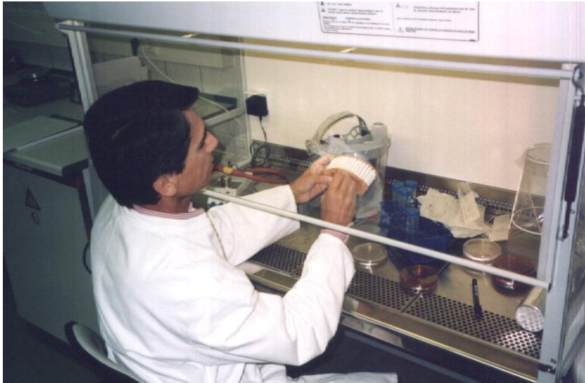
Abbildung 5: Arbeit an einer Sicherheitswerkbank der Klasse 2.
