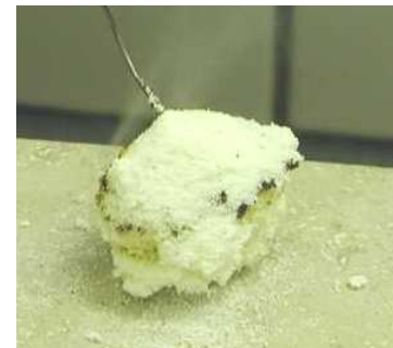
Bild 1: Ein im Labor erzeugtes Glimmnest aus Milchpulver.
