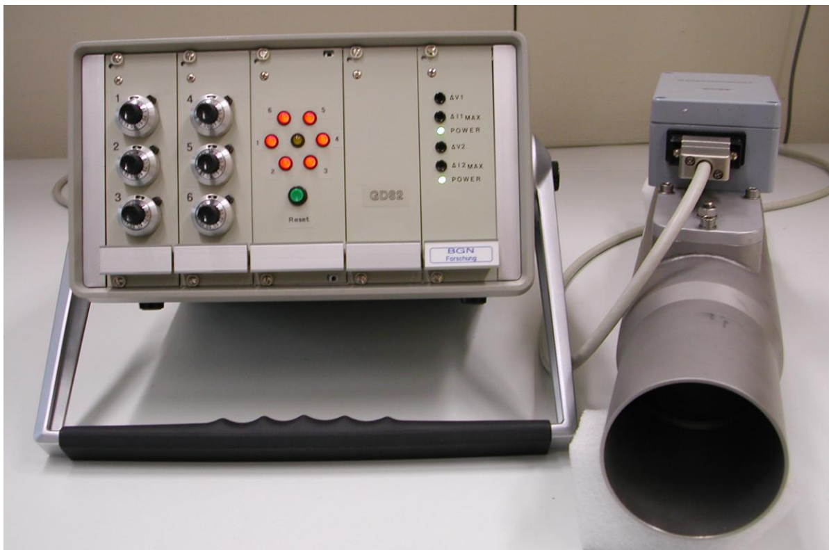
Abbildung 1: Der aktueller Prototyp eines Glimmnestererkennungsystems namens GDS 2 der FSA.
