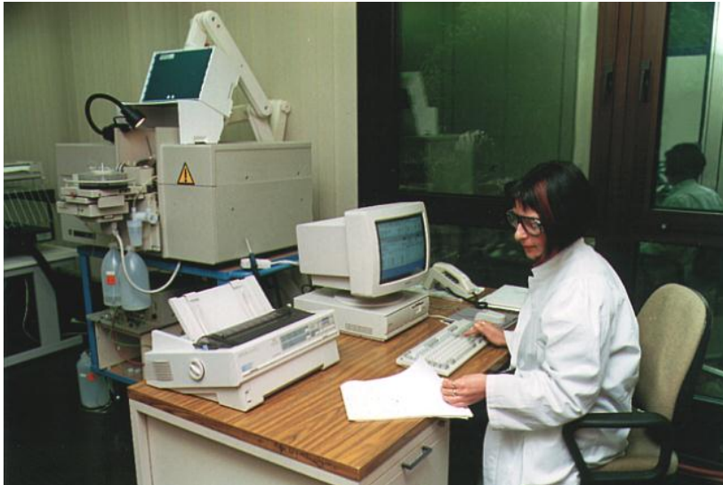
Abbildung 2: Messung der Metallbelastung an genommenen Proben mit dem Atomabsorptionsspektrometer.
