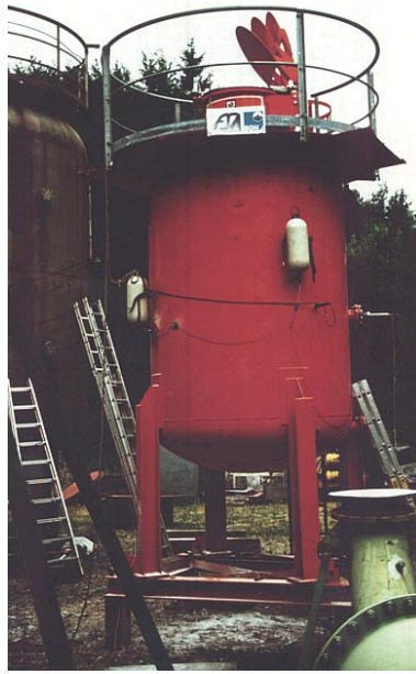
Abbildung 3: Versuchsreihe zur Bestimmung der Kraftwirkung auf Scharniere von Explosionsklappen. 9,4 m 3 -Silo auf dem Versuchsgelände Kappelrod-eck.
