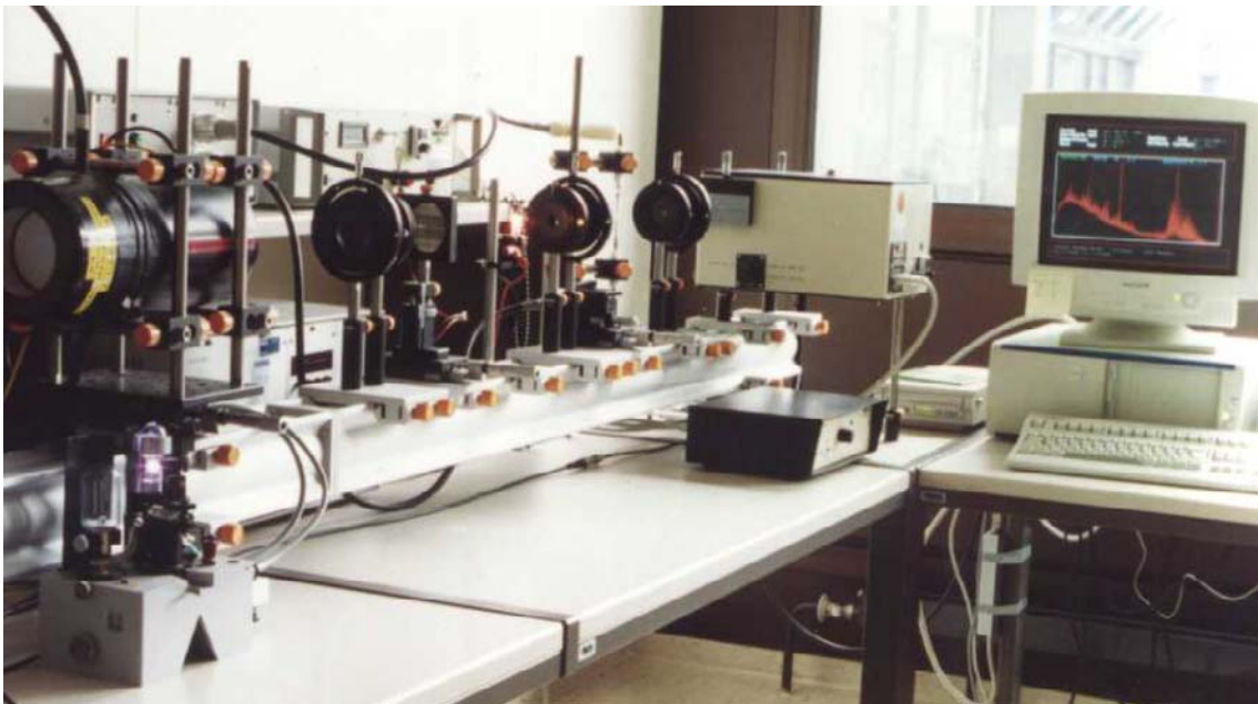
Abbildung 5: Experimenteller Aufbau zur Temperaturmessung an elektrostatischen Zündfunken. Experimental set-up for measurement of temperature on electrostatic ignition sparks
