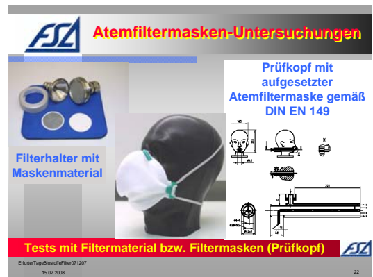
Abbildungen 1 und 2: Filterprüfstand und Materialhalter bzw. Prüfkopf mit aufgesetzter Filtermaske
