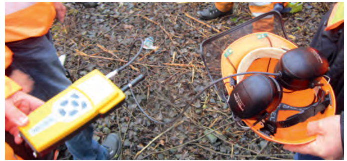
Abb. 1: Testgerät der Fa. Zöllner Signal GmbH (Stand März 2012): Das Warngerät für das akustische Signal ist fest im Gehörschutz integriert. Der Gehörschutz ist am Helm mit Visier angebracht. Das Headset ist mit Kabel am Empfangsgerät angeschlossen.
