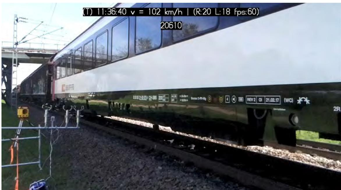
Abbildung 4.4: Screenshot eines vom Mikrocomputer-Kamerasystem erfassten Güterzuges mit Personen- und Güterwagen-Kombination (Zug 4).
