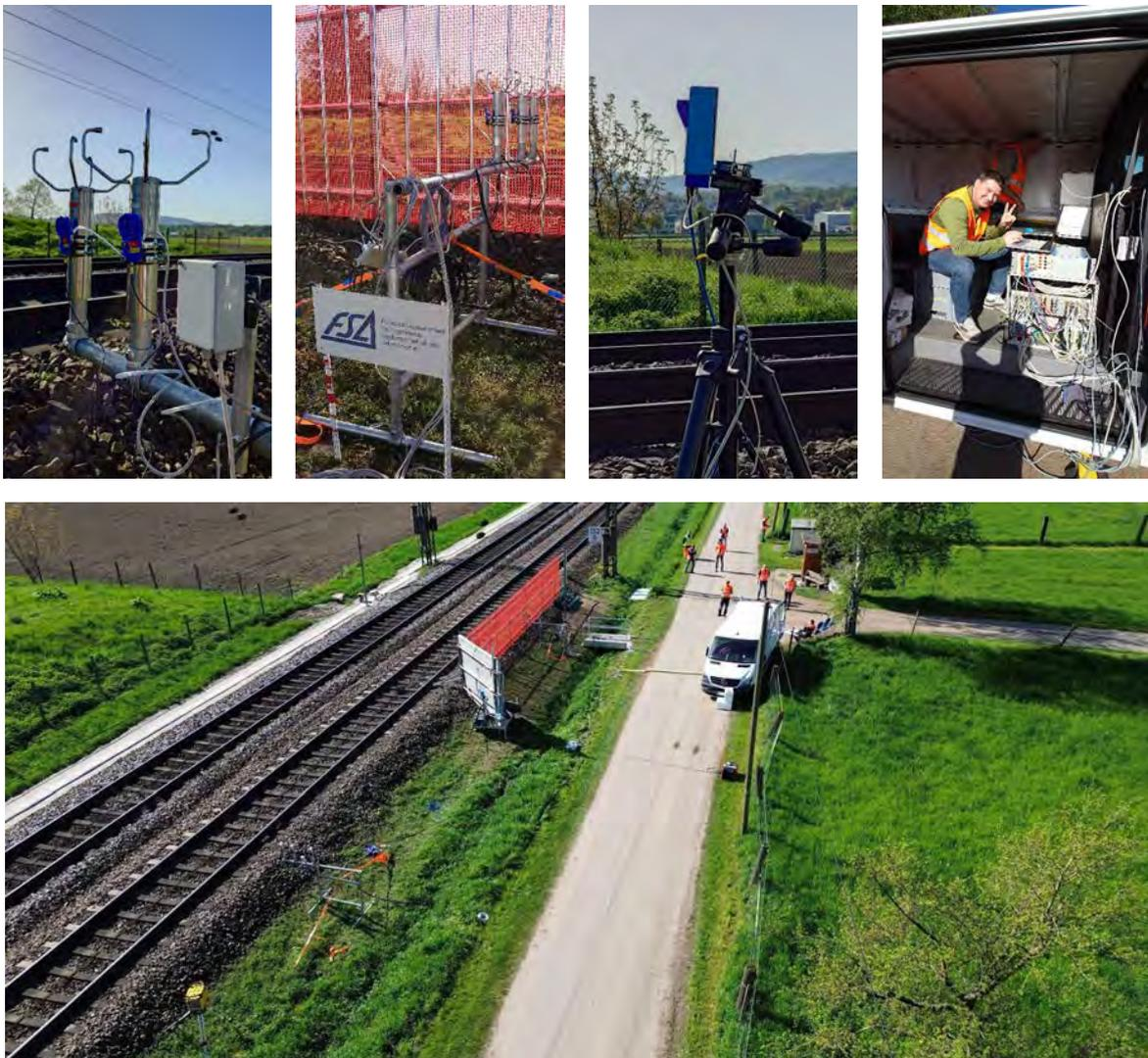
Abbildung 4.3: Oben von links nach rechts: Ultraschallanemometer mit Drucksensoren vor der Windsperre mit Radar, hinter der mobilen Schnellbauwand, Mikrocomputer mit Kamera, Paul Schupin mit Spannungsversorgung und Transientenrekorder. Unten: Gesamtüberblick.
