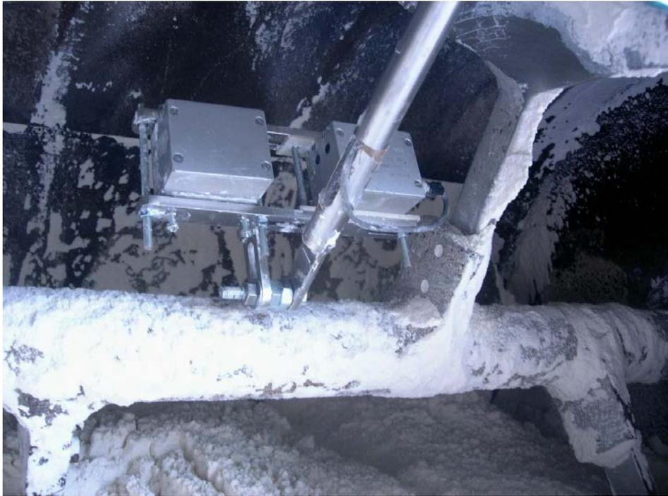
Abbildung 4.7: Messereinheit Typ 15 am Messpunkt 1 bei der Messung mit Maisstärke bei  $\Gamma = 25\%$  und  $v_U = 2,3$  m/s.
