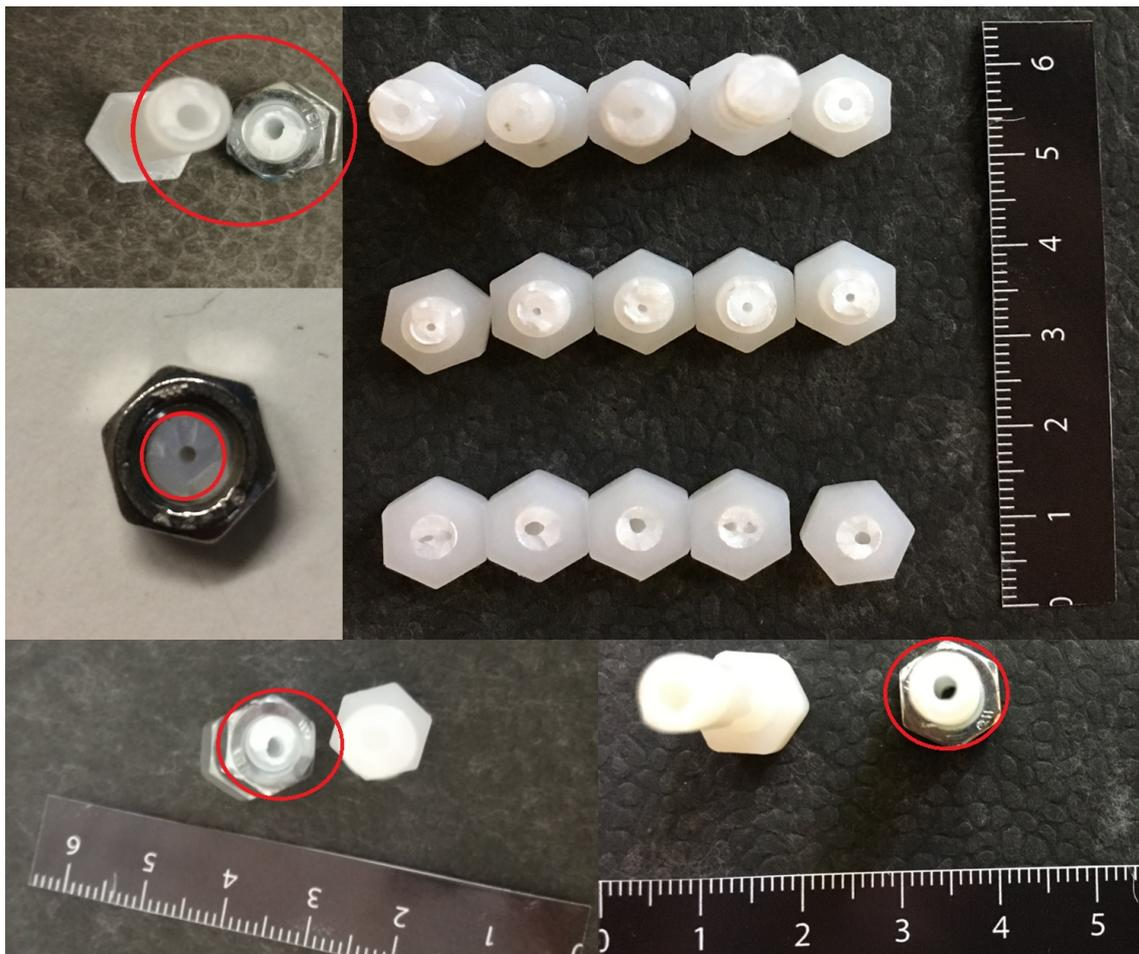
Abbildung 3.24: Zusammenstellung verschiedener Fehlstellen in Polyamidschrauben der Lieferanten Kunststoffschraube.de, Emico und Würth.
