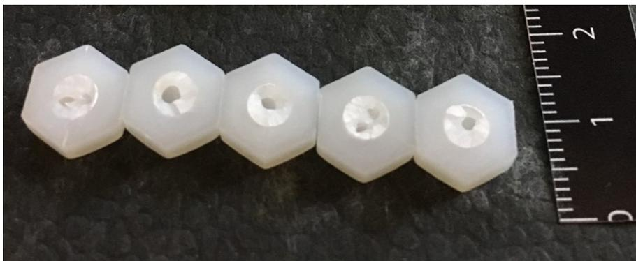
Abbildung 3.23: Fehlstellen in den Polyamidschrauben des Lieferanten Würth.
