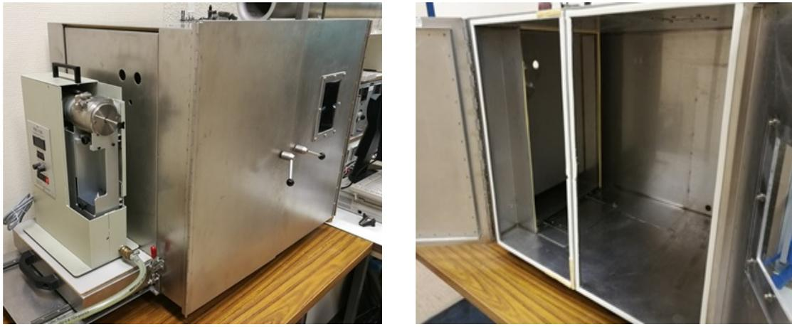
Abbildung 3.10: Staubkammer mit Dosierschlitten und Dosiereinheit RBG 1000 (links). Staubkammer geöffnet ohne Inneneinbauten (rechts).
