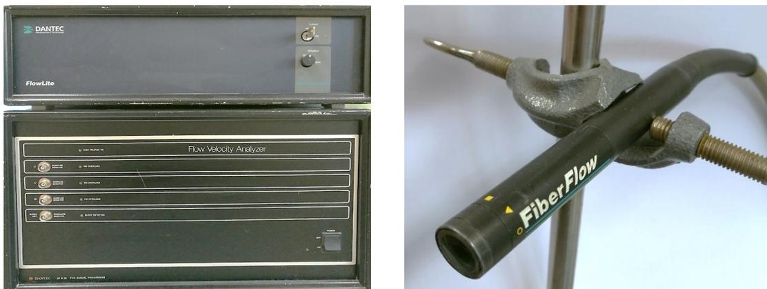
Abbildung 3.8: Messgerätschaften bestehend aus FlowLite (links, oben) und Flow Velocity Analyzer (links, unten) sowie der Messsonde FiberFlow (rechts).
