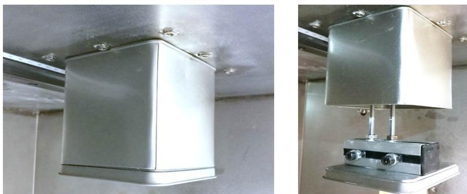
Abbildung 4.2: Probenehmer zur Aufnahme eines Partikelbildes zur visuellen Beurteilung der Agglomeratbildung innerhalb der Staubkammer.
