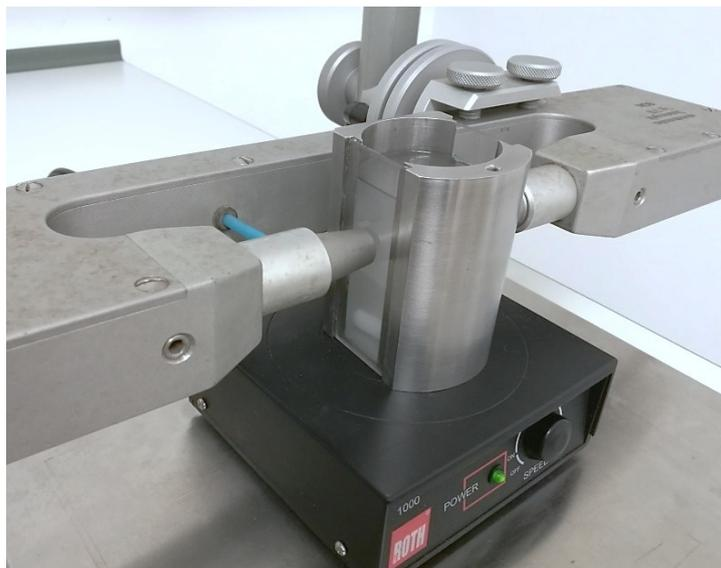
Abbildung 3.4: Vorrichtung zur Erfassung der Kalibrierkurve des SKG. Der Messkopf durchleuchtet ein mit Ethanol gefülltes Kalibriergefäß. Eine Rührplattform sorgt für eine ausreichende Durchmischung des Feststoffes in der Kalibrierflüssigkeit.
