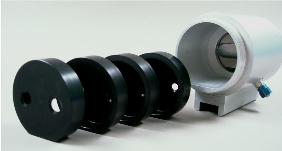
Abbildung 2.5: Die in die Zylindergehäuse eingebauten Blenden schützen die optischen Elemente der Messeinheit vor Verschmutzung.
