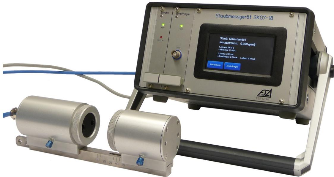
Abbildung 4.1: Fotografie der aufgebauten Steuereinheit SKG 7 mitsamt angeschlossener Messeinheit Typ 18.
