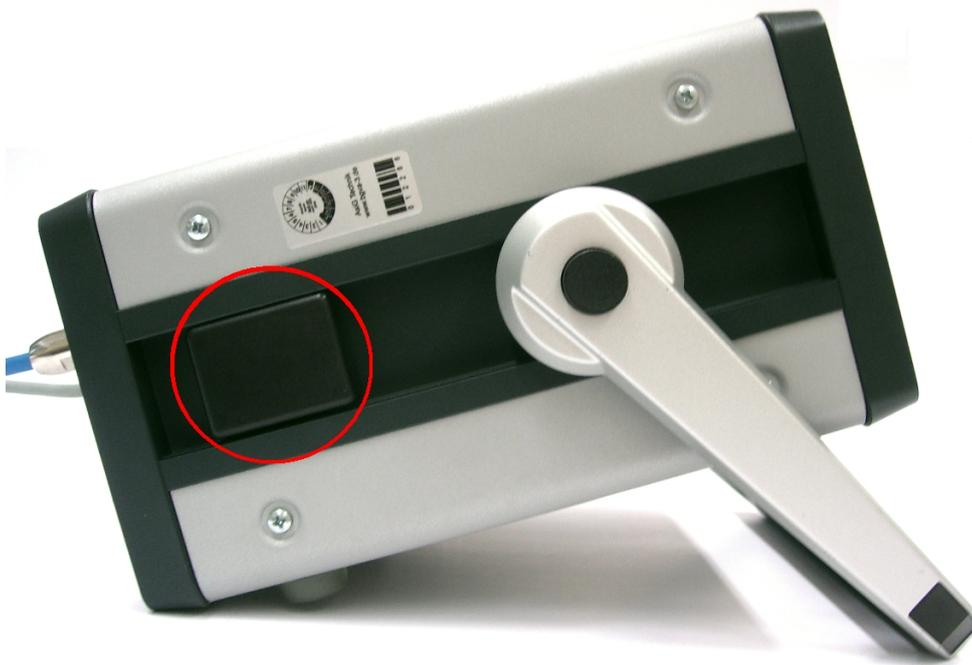
Abbildung 4.12: Gehäuse mit dem Sensor für Temperatur- und Feuchtemessung.
