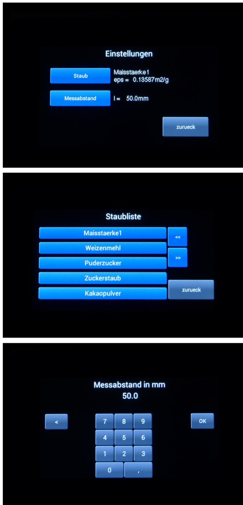
Abbildung 4.18: Menü Einstellungen (oben). Menü zur Auswahl eines Staubes für eine Messung (Mitte). Menü zur Eingabe des Messabstandes  $l$  (unten). Die Standardeinstellung für den Messabstand beträgt  $l = 50$  mm.
