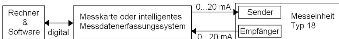
Abbildung 3.3: Betrieb der Messeinheit Typ 18 über einen Rechner mit eingebauter PC-Karte und Steuer- und Auswertesoftware (schematisiert).
