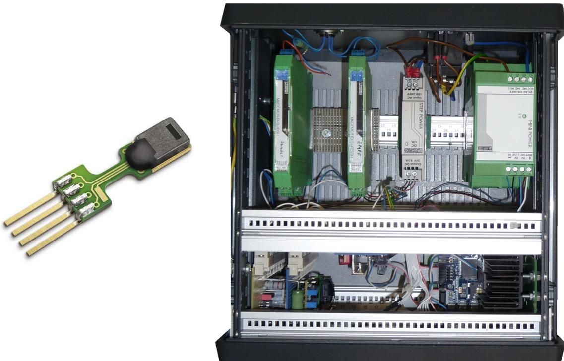
Abbildung 4.7: Sensor SHT75 von Sensirion für die Temperatur- und Luftfeuchtemessung (links) und Blick von oben in die geöffnete Steuereinheit (rechts).
