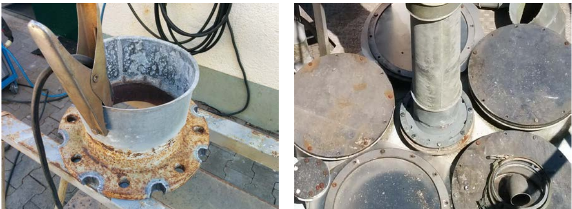
Abbildung 3.3: Präpariertes Adapterstück (links). Montiertes Adapterstück mit übergeworfenem Kreisring (rechts).
