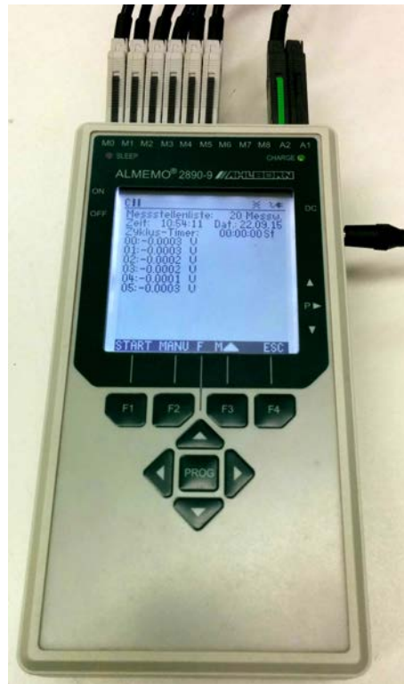
Abbildung 2.6: Foto des Datenloggers ALMEMO 2890-9 der Firma Ahlborn.
