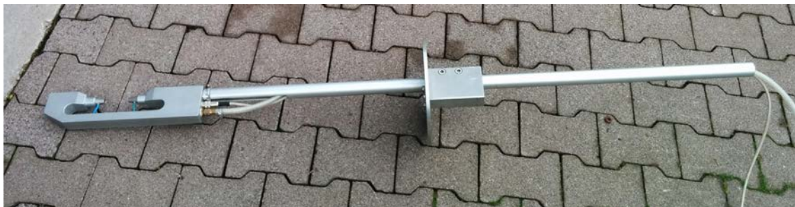
Abbildung 3.6: Zur Montage im Silo vorbereiteter Messkopf.
