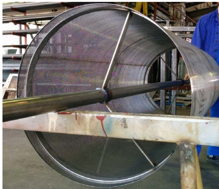
Abbildung 3.15: Montierte Welle der Trommelsiebmaschine.
