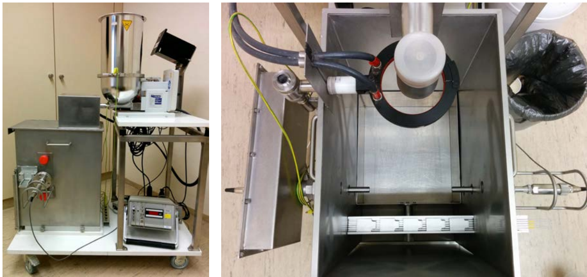
Abbildung 3.11: Apparatur zur Bestimmung der Staubungszahl im Zentrallabor der BGN in Mannheim (links). Blick in die Messkammer der Apparatur (rechts). Am unteren Bildrand sind die fünf Metallschlitzen mit den Glasplättchen zu sehen.
