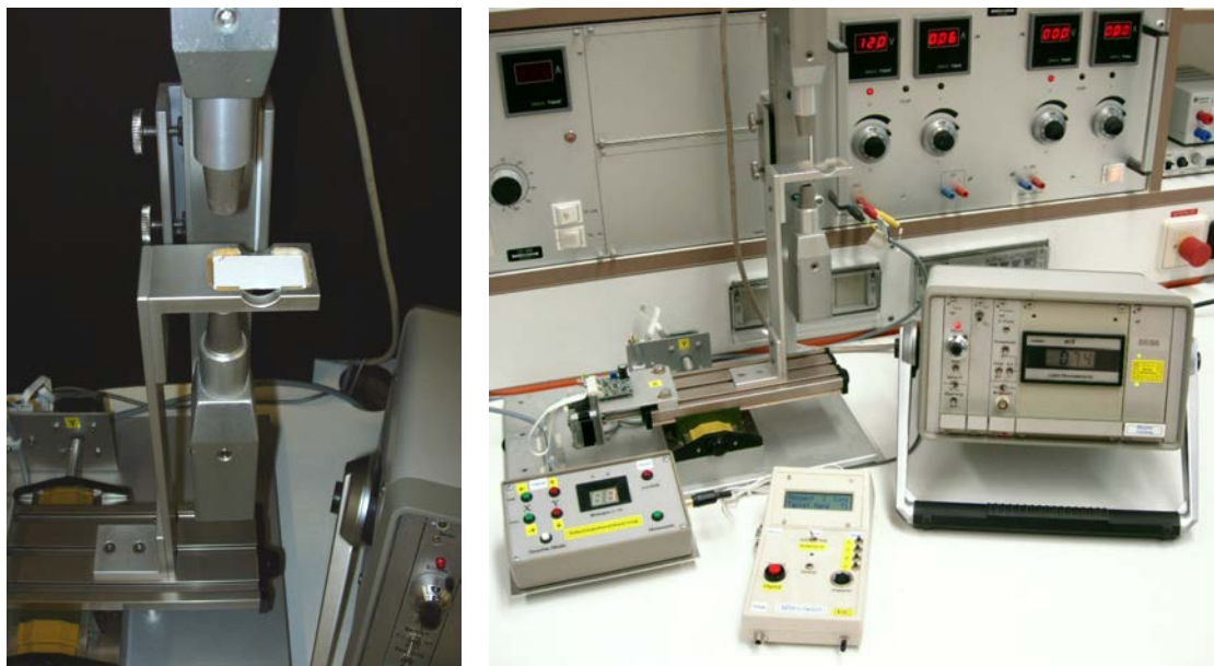
Abbildung 3.12: Glasplättchenhalterung der Kalibrierstation (links). Übersichtsfoto der Kalibrierstation (rechts).
