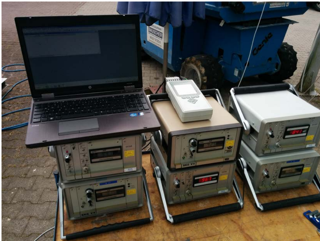
Abbildung 3.9: Messstand mit den sechs SKG 5-Steuergeräten, dem ALMEMO-Datenlogger und einem Laptop zum Auslesen der Messdaten.
