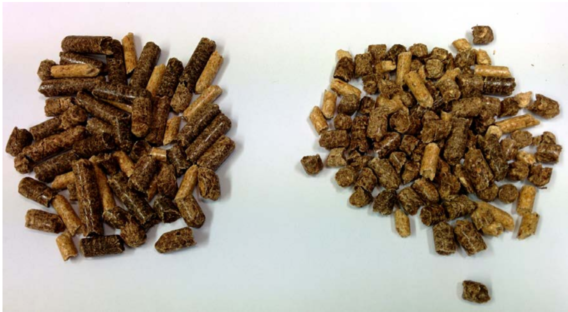
Abbildung 4.3: Holzpellets vor (links) und nach (rechts) der Versuchsreihe.
