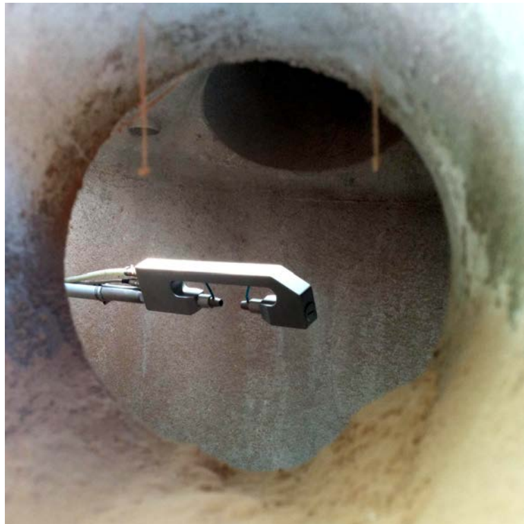
Abbildung 3.8: In das Silo eingeführter Messkopf des Staubkonzentrationsmessgeräts (Blick durch einen Flansch an der seitlichen Silowand).
