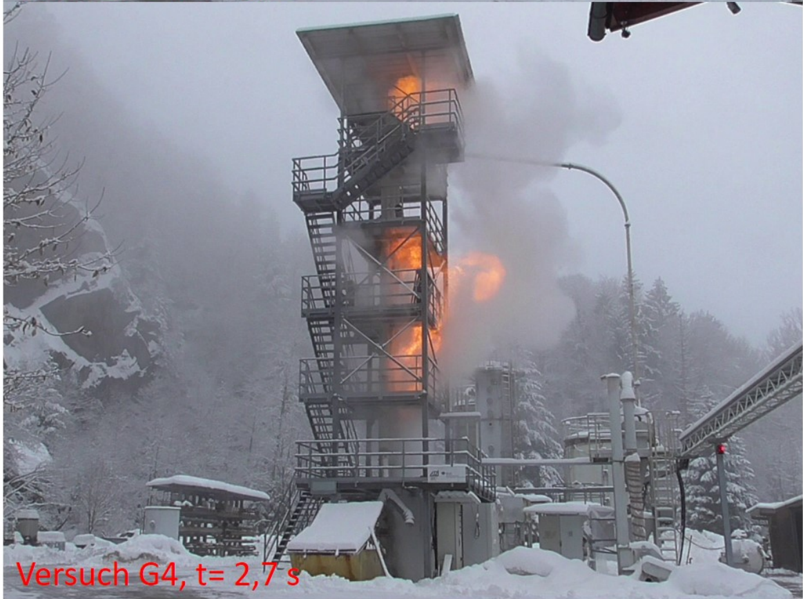
Abbildung 4.4: Ausschnitt der bei Versuch G4 erstellten Videosequenz zum Zeitpunkt t= 0,2 s und t= 2,7 s nach der Zündung.
