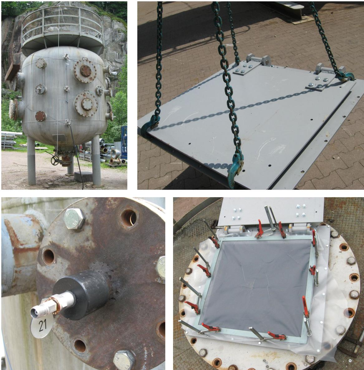
Abbildung 4.9: Der 27 m<sup>3</sup>-Behälter auf dem Versuchsfeld Kappelrodeck (links oben). Montage des Druckentlastungsöffnungsflansches (rechts oben). Einer der beiden angeflanschten Drucksensoren (links unten). Die mit Kunststofffolie verschlossene Druckentlastungsfläche (rechts unten).
