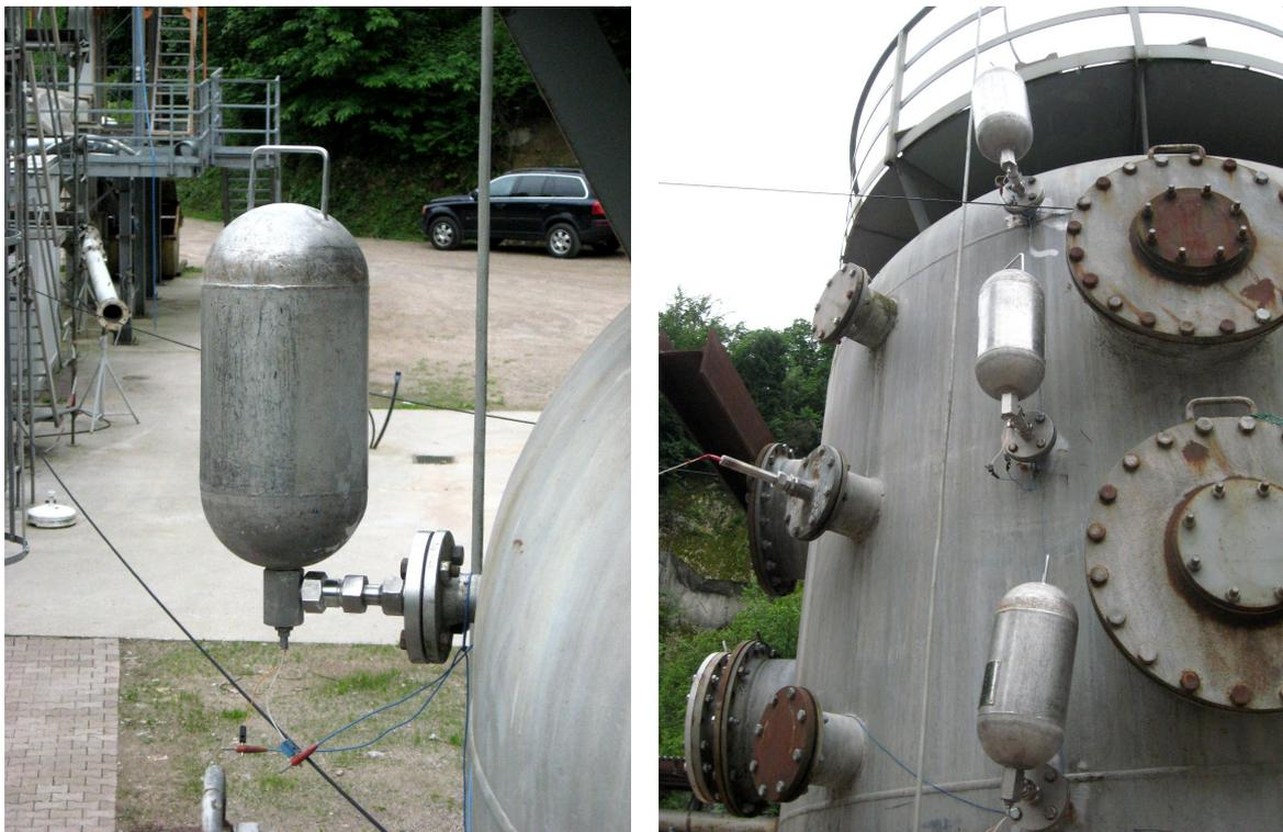
Abbildung 4.10: Unter Überdruck stehende Staubvorratsflaschen mit Sprengkapselventilen fertig montiert am 27<sup>3</sup>-Behälter.
