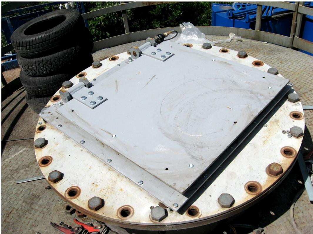
Abbildung 4.11: Der an der Druckentlastungsklappe befestigte Inkrementaldrehgeber (oben). Die auf dem 27<sup>3</sup>-Behälter montierte Druckentlastungsklappe (unten).
