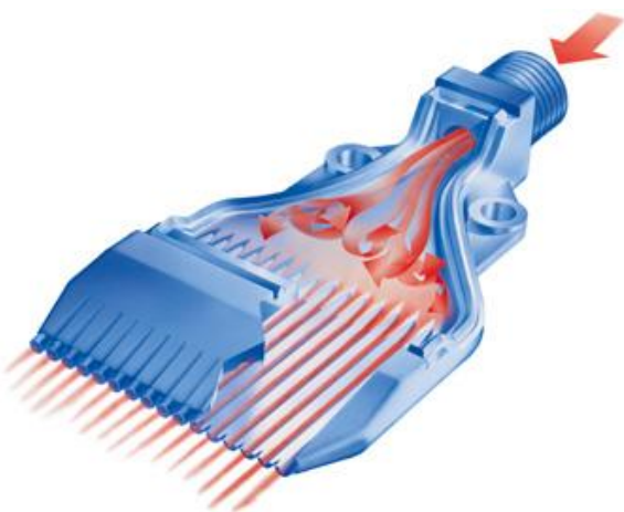
Abbildung 18: Windjet - Mehrkanaldüsen gelten bereits als geräuscharm; Quelle: [16]
