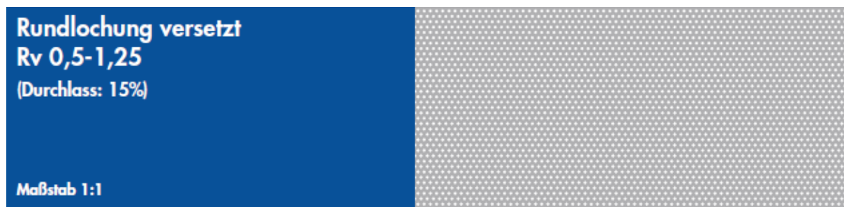
Abbildung 47: Rundlochung versetzt; 15% Lochflächenanteil
