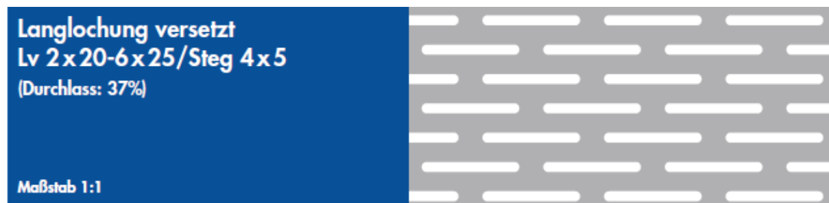
Abbildung 49: Langlochung versetzt; 37% Lochflächenanteil
