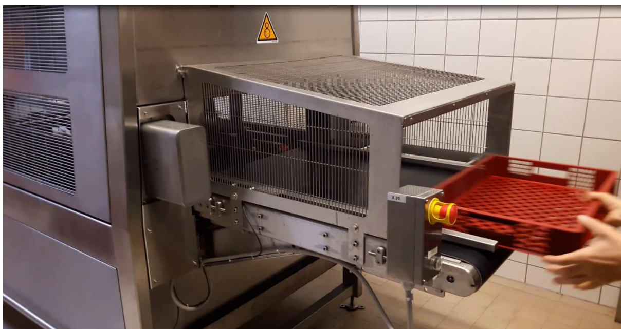
Abbildung 29: Auslauf einer einfachen Zentrifugentrocknung
