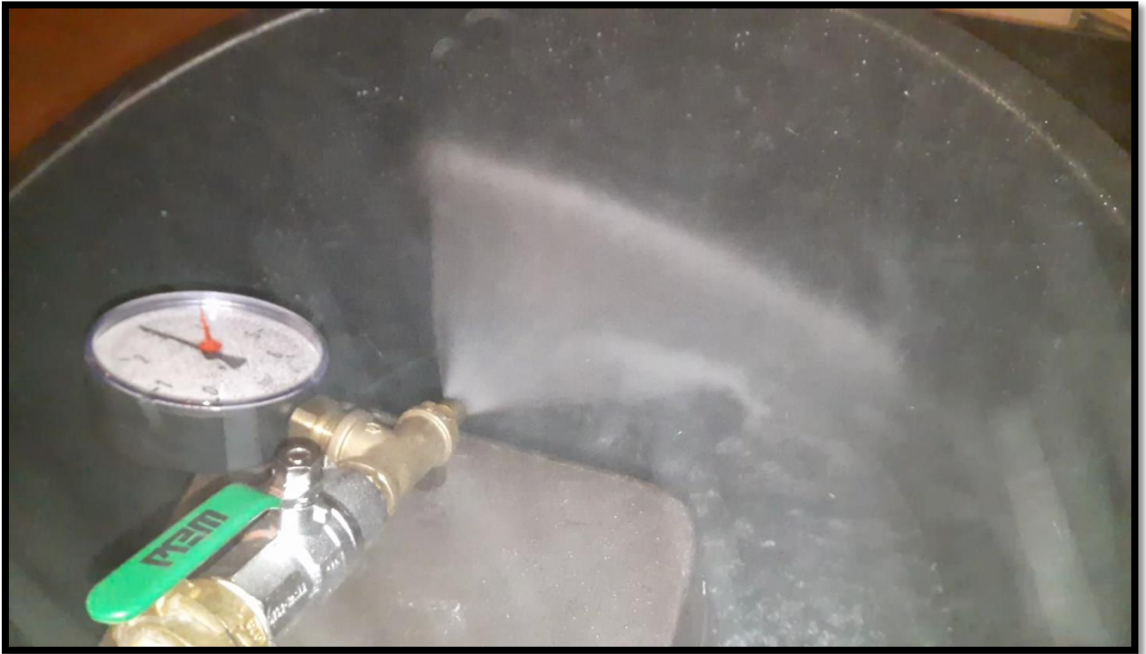
Abbildung 14: Schallpegelmessung einer Flachstrahldüse BETE NF60
