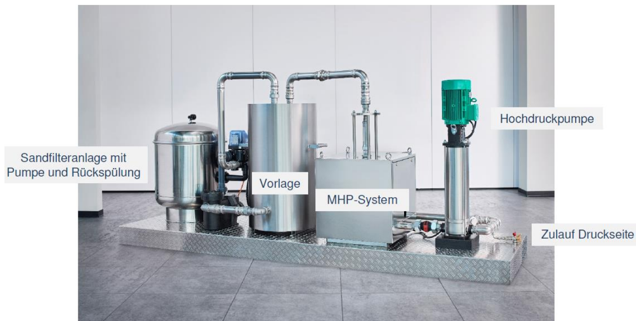
Abbildung 53: MHP-System in vollständiger Ausbaugröße
