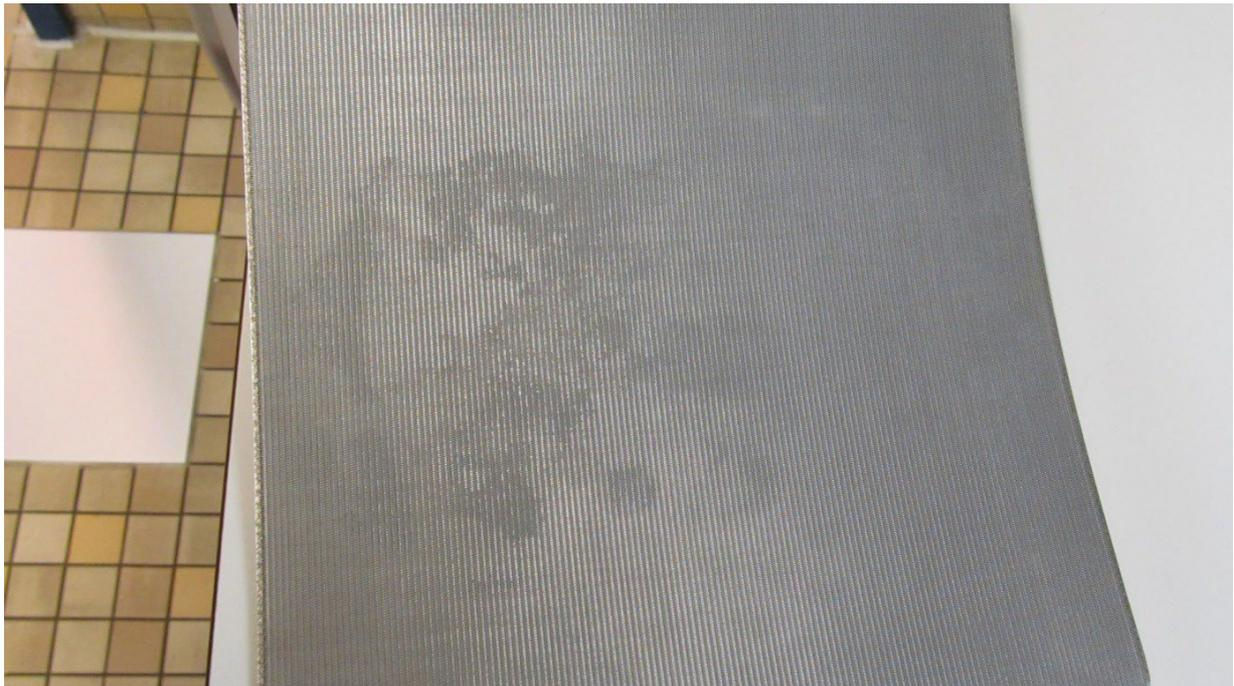
**Abb. 6 Stereomikroskopischer Befund des Prüfkörper nach Mucosal 0,7 % - Behandlung**
