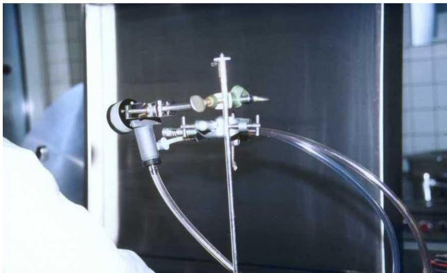
**Abbildung 2 Probenahmesystem in der Küche**
