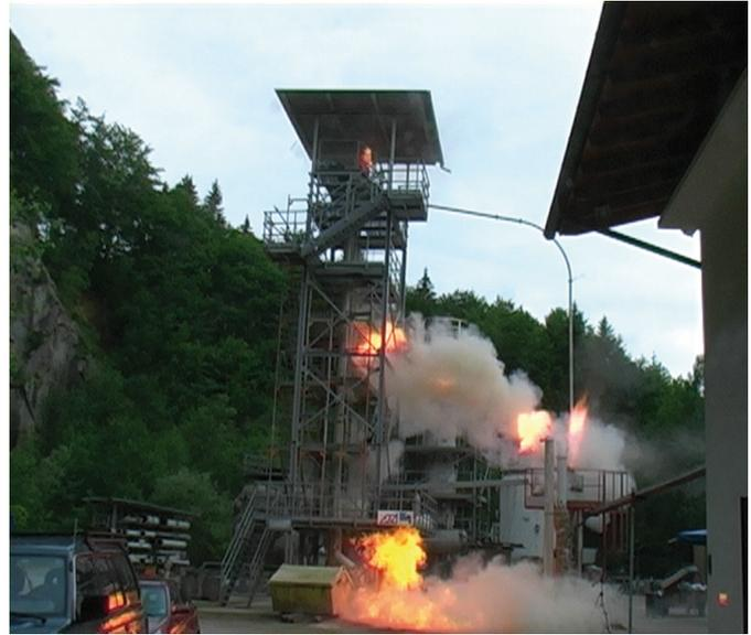
**Bild 1** Malzstaubexplosion in einem druckentlasteten Becherelevator auf dem Versuchsgelände der BGN/FSA mit Explosionsübertragung in die Entstaubungsanlage [3].
