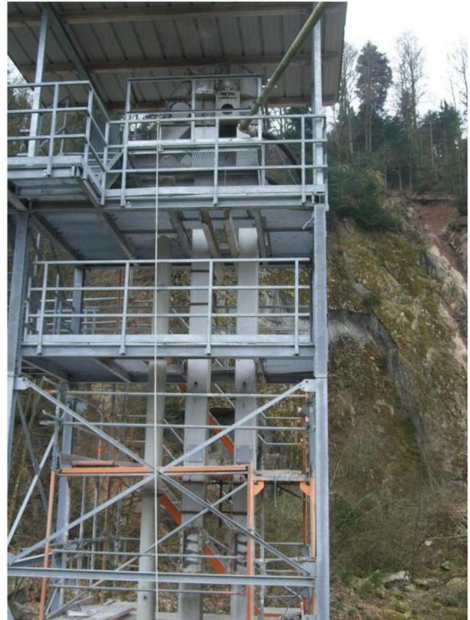
**Bild 3** Eingerüsteter Becherelevator auf dem Versuchsfeld der BGN/FSA in Kappelrodeck.
