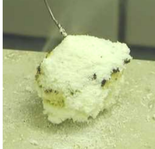
Bild 3: Im Labor erzeugte Glimmester aus Stahlwolle (links) bzw aus Milchpulver (rechts), welche innen glühen.
