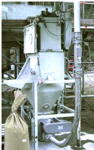
Bild 5: Detektionskörper mit aufgeweitetem Rohrstück eingebaut in die pneumatische Förderanlage auf dem Versuchsfeld in Kappelrodeck (links). Ein von einem Glimmnest in einer Maisstärkeförderung (Konzentration: 20 \text{ kg/m}^3 , Fördergeschwindigkeit: 20 \text{ m/s} ) erzeugtes Spannungssignal nach dem Verstärkerausgang des GDS 2 (rechts).
