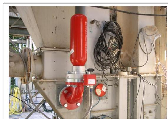
Bild 2: Becherelevator mit Löschmittelbehältern verschiedener Hersteller
