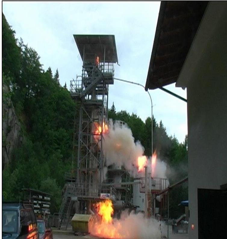
Bild 3: Staubexplosion im druckentlasteten Becherelevator auf dem Versuchsfeld der BGN / FSA in Kappelrodeck mit Explosionsübertragung durch die Entstaubungsleitung DN 100 (Länge  $l = 15$  m) in den druckentlasteten Zyklon [6].
