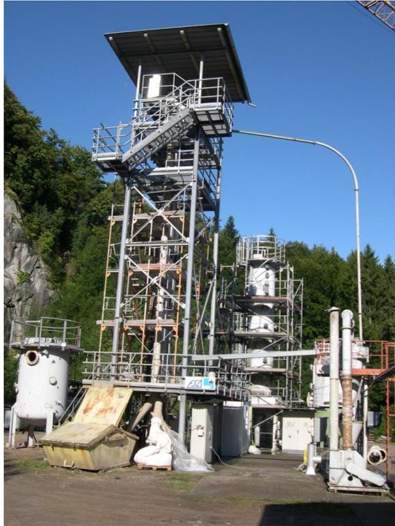
Bild A1: Eingerüsteter Becherelevator mit Entstaubungsleitung
