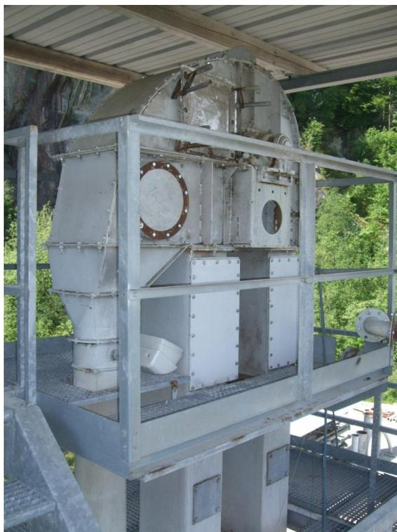
Bild A4: Elevatorkopf
