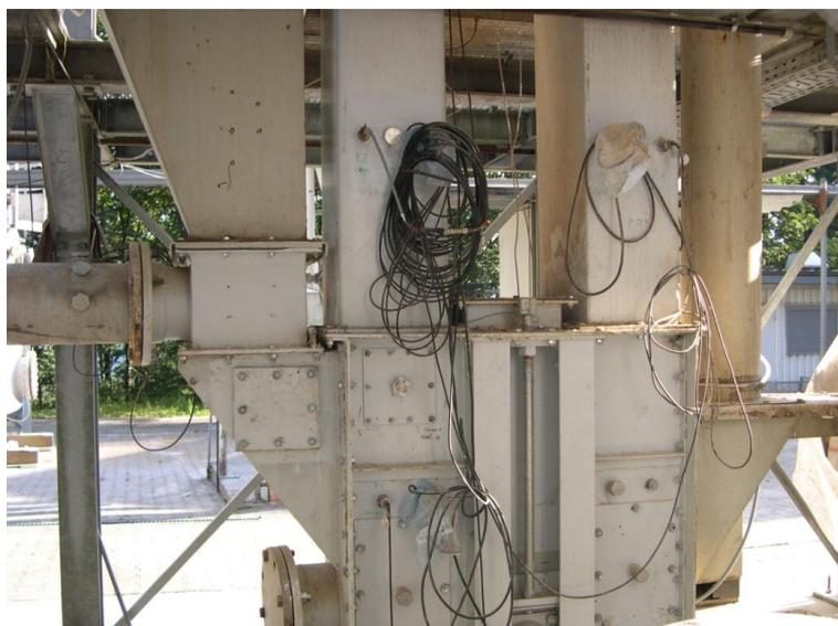
Bild A2: Elevatorfuß mit Einlaufrohr (linke Seite) und Fallrohr (rechte Seite)
