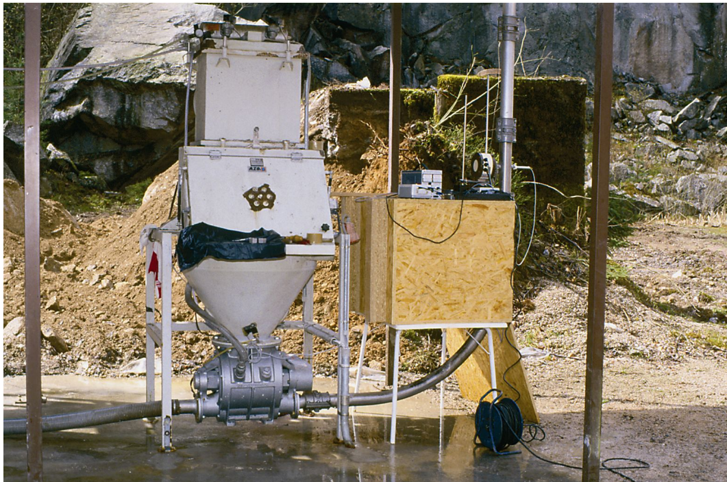
Abbildung 2.9: Experimenteller Aufbau zur Untersuchung der Abhängigkeit des Sensorsignals von Glimmnesttemperatur und Staubkonzentration an einer pneumatischen Förderleitung. Oben: Senkrecht verläuft die Förderleitung. Im Vordergrund ist der Sensor zu sehen, im Hintergrund erkennt man den Chopper sowie den Ofen zur Beheizung des Kupferblocks. Unten: Links neben Förderleitung, Sensor und Ofen befindet sich die Zellenradschleuse, mit deren Hilfe das Förderprodukt in den Luftstrom gegeben wird.
