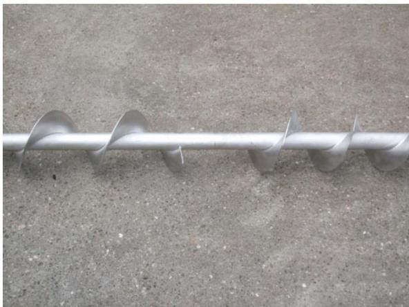
Bild 3: Förderschnecke mit einem entfernten Schneckengang (Pfpfenlänge 180 mm)
