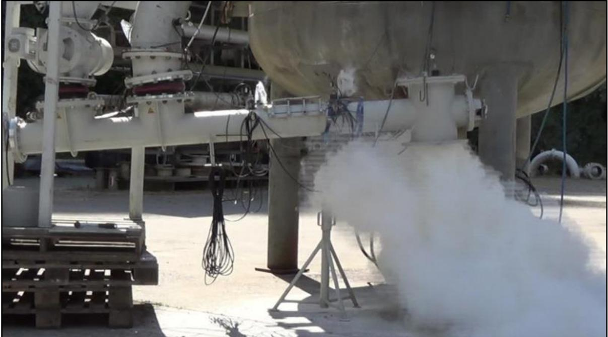
Bild 9: Explosionsversuch mit Cellulose ohne Flammenaustritt
