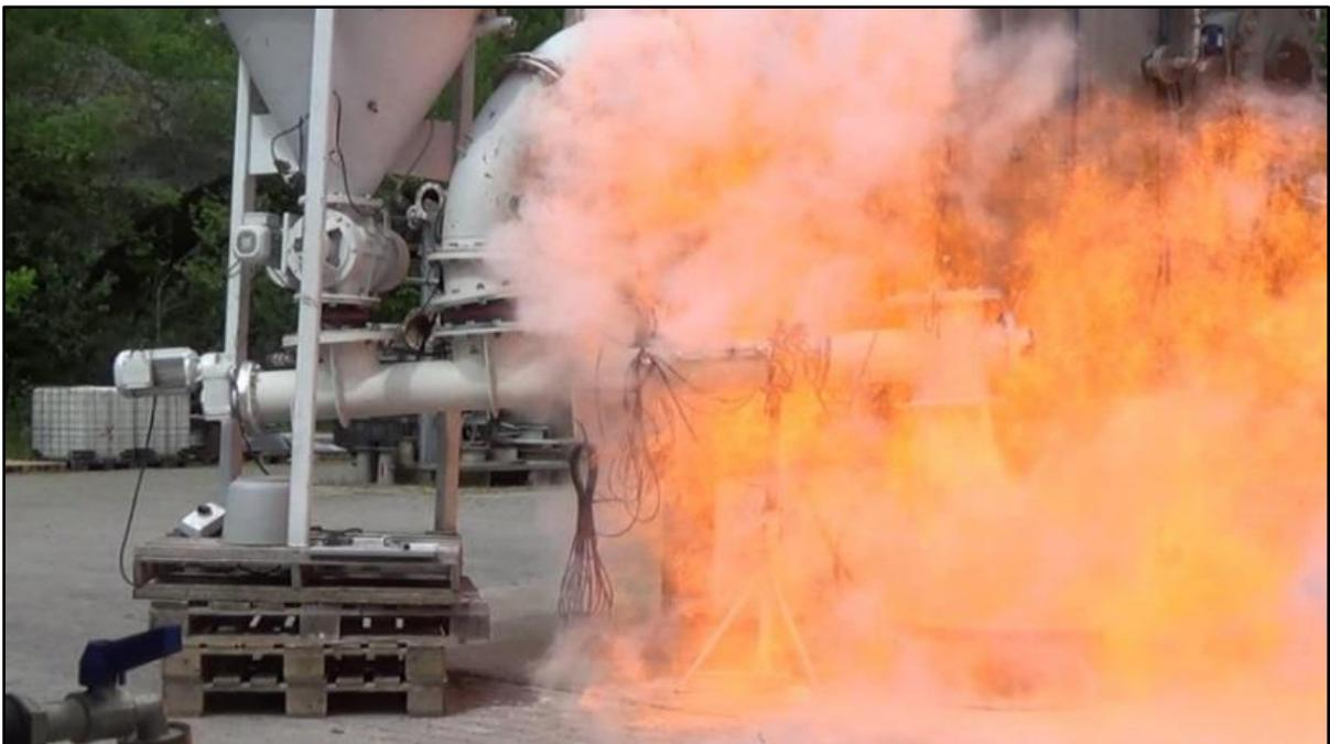
Bild 10: Maisstärkeexplosion mit Flammenaustritt aus dem Rohrschneckenförderer
