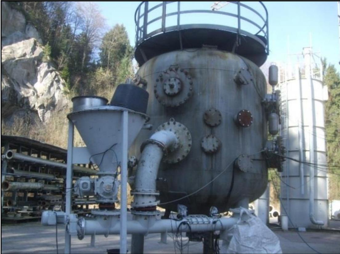
Bild 6: Praktische Realisierung des Versuchsaufbaus mit 26 m<sup>3</sup> - Explosionsbehälter. Im Vordergrund sind die Rohrförderschnecke und die Schüttgutaufgabe zu sehen.
