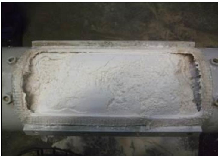
Bild 8: Schüttgüter mit und ohne Pfropfenbildung: Keine Pfropfenbildung mit leichtfließender Maisstärke (oben) und Pfropfenbildung mit kohäsivert Cellulose (unten)
