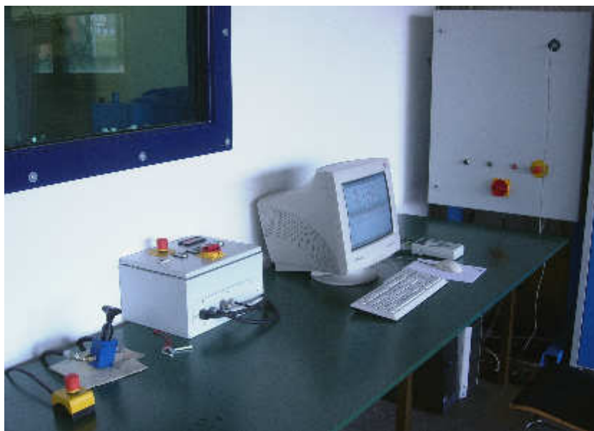
Abbildung 2.8: Experimenteller Aufbau zur Untersuchung der Entstehung heißer Oberflächen durch Reibvorgänge.
