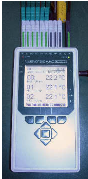
Abbildung 2.3: Datenlogger der Firma Ahlborn. Auf 10 Kanälen werden die Messdaten bei jedem Versuch erfasst.
