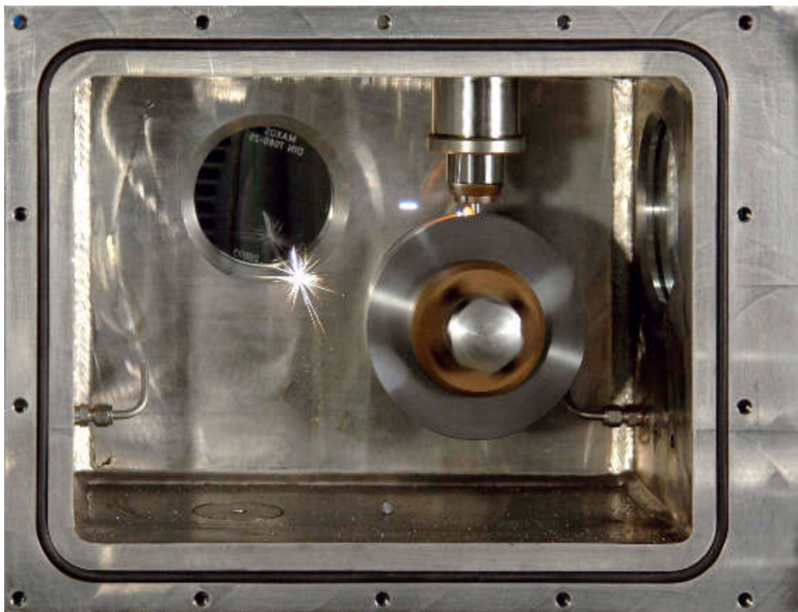
Abbildung 5.1: Gesamtbild der Reibfunkenapparatur der PTB (oben) und Foto der Reibscheibe mit Reibstift im Inneren der Kammer zur Aufnahme des Brennstoff/Luft-Gemisches (unten) [8].
