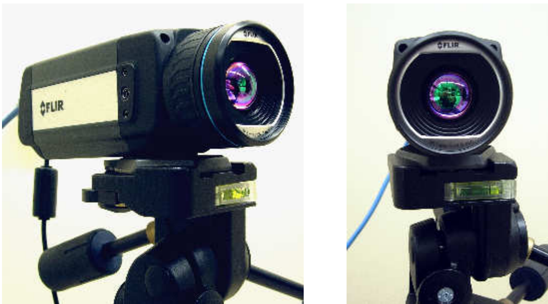
Abbildung 2.6: Mikrobolometer SC655 der Firma FLIR.
