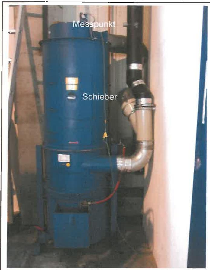
Mit dem hinter der 150 mm-Leitung liegenden Schieber kann ebenfalls Falschluf zur Regelung der Luftgeschwindigkeit in der Versuchseinrichtung eingesaugt werden.
