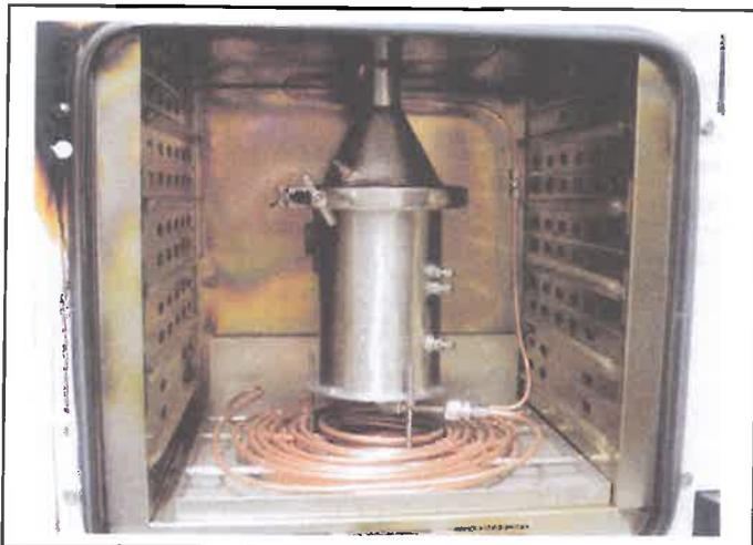
Bild 2 Im Wärmeschrank eingebauter Versuchsbehälter
