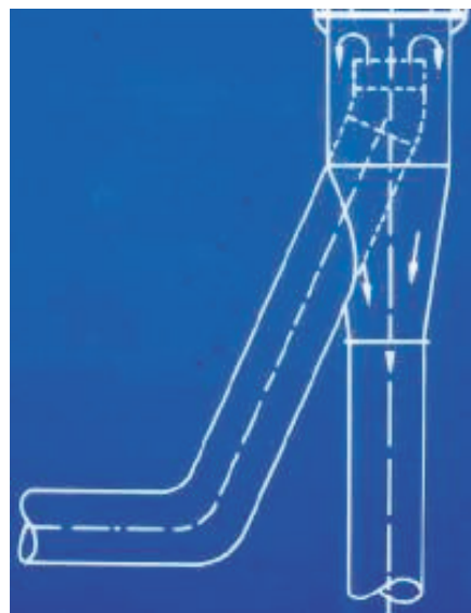
Bild 1 Prinzipbild eines Entlastungsschlots (links) und praktische Realisierung (rechts).
