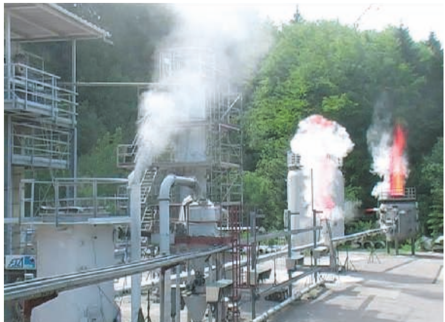
Bild 5 Momentaufnahme eines Explosionsversuchs auf dem Versuchsgelände der BGN/IFA in Kappelrodeck. Auf dem Bild ist rechts noch die abklingende Flamme der Primärexplosion zu sehen, links daneben der Flammen- und Staubaustritt aus dem Entlastungsschlot.
