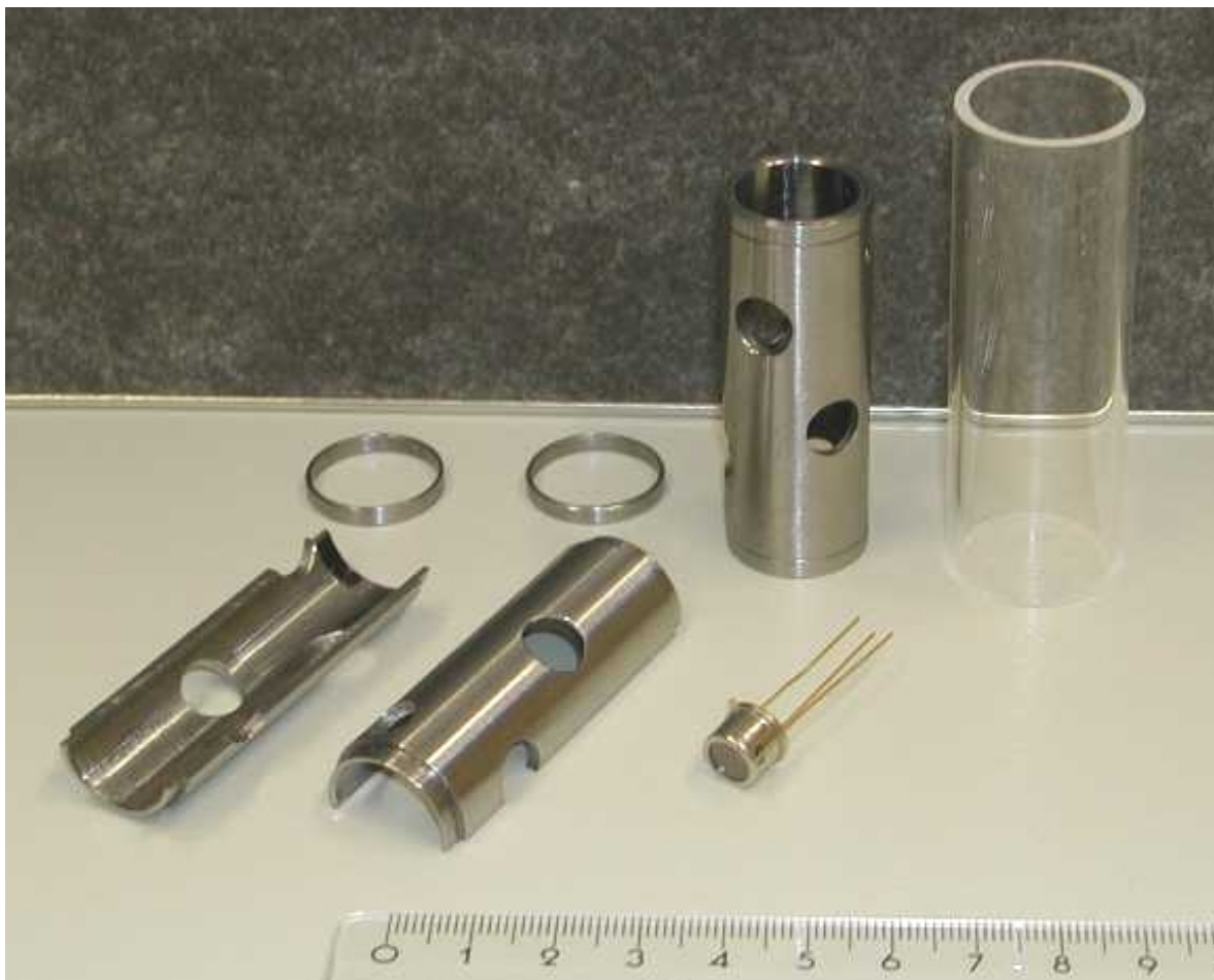
Abbildung 3.13: Die Metallhülse für die Sensoren (zerlegt und zusammengesetzt), einer der Sensoren und einer der verwendeten Glaszylinder.
