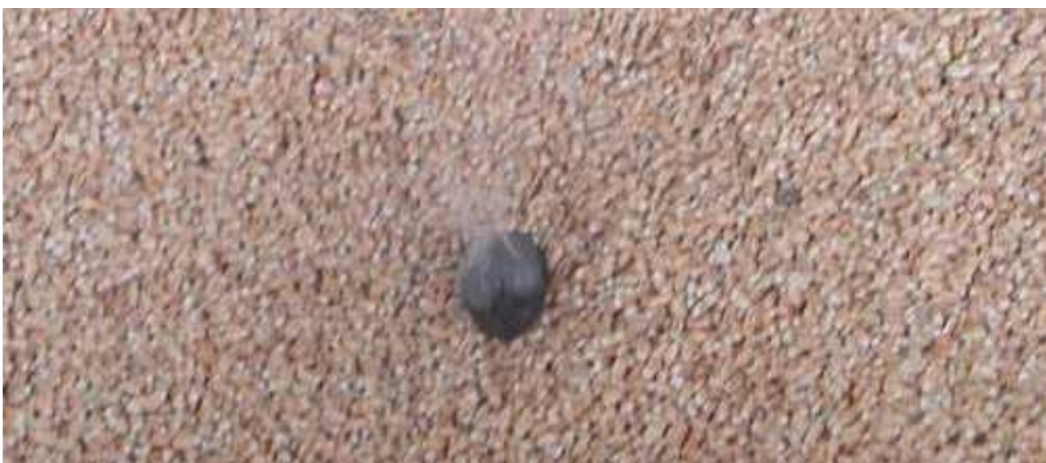
Abbildung 4.7: Oxidierende (glühende) Stahlwollekugel in Weizenschüttung.
