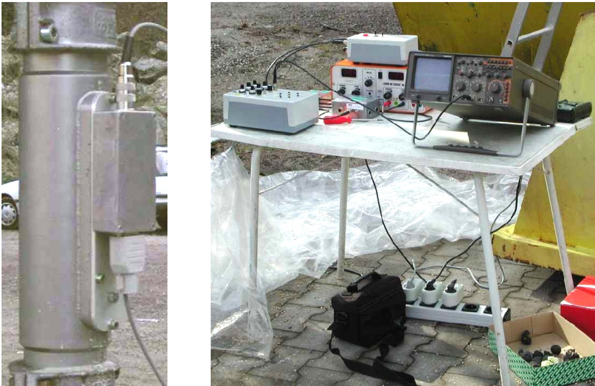
Abbildung 4.6: Detektionssystem in der Rohrleitung und dazugehörige Elektronik auf dem Versuchsgelände.
