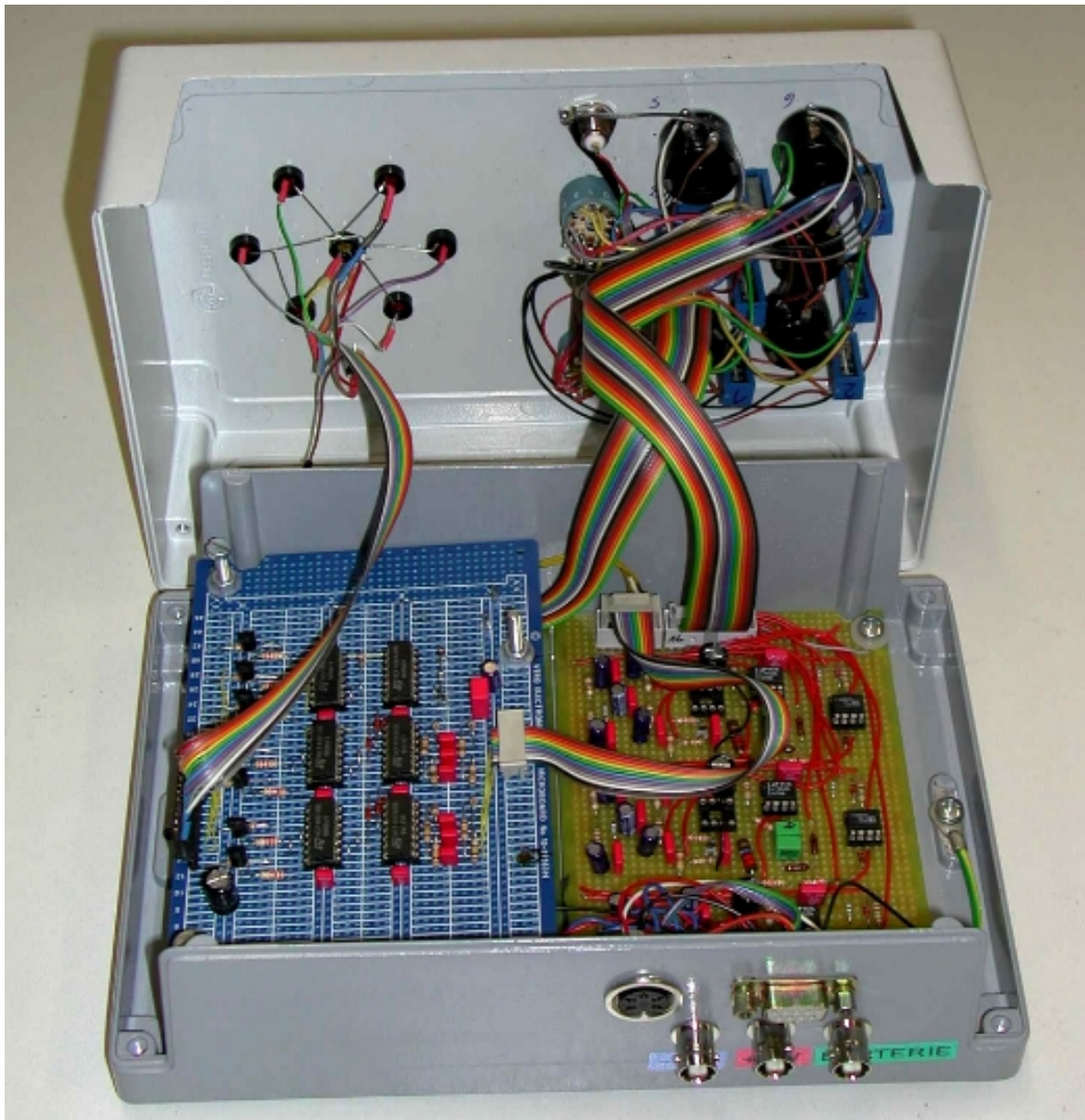
Abbildung 3.21: Offenes Metallgehäuse mit Verstärker- und Logikschaltung.
