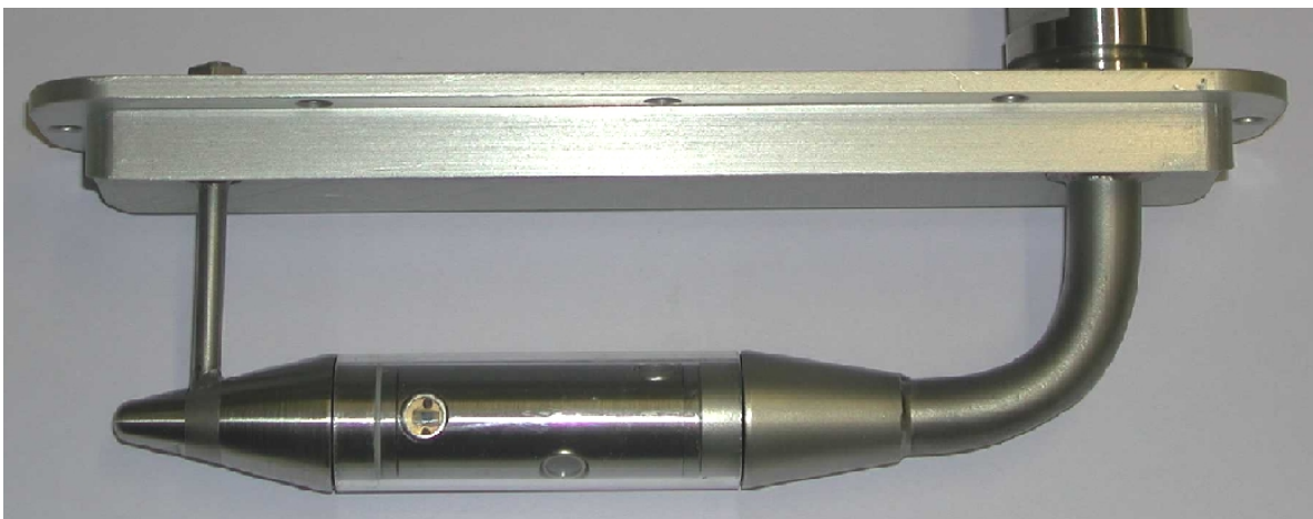
Abbildung 3.12: Fertig aufgebauter Detektionskörper montiert an seiner Aufhängung (Befestigung). Links in der Abbildung ist die vordere Befestigung des Detektionskörpers zu sehen, rechts die hintere Befestigung.
