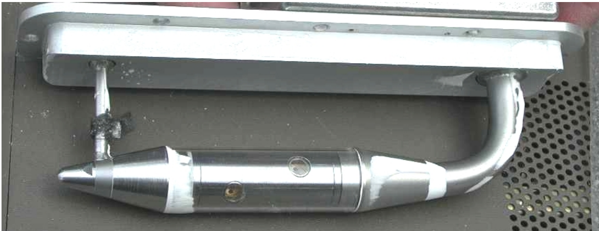
Abbildung 5.1: Detektionskörper nach mehrstündigem Betrieb in Maisstärke. Links im Bild: Das Fragment einer Stahlwollekugel hat sich an der Aufhängung des Detektionskörpers verfangen.
