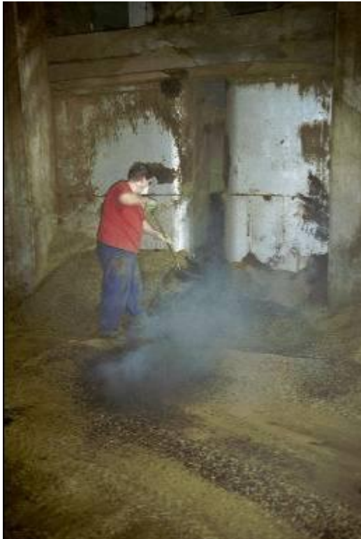
Durch exotherme chemische Reaktion (Selbstentzündung) während der Lagerung entzündete Hopfenpellets
