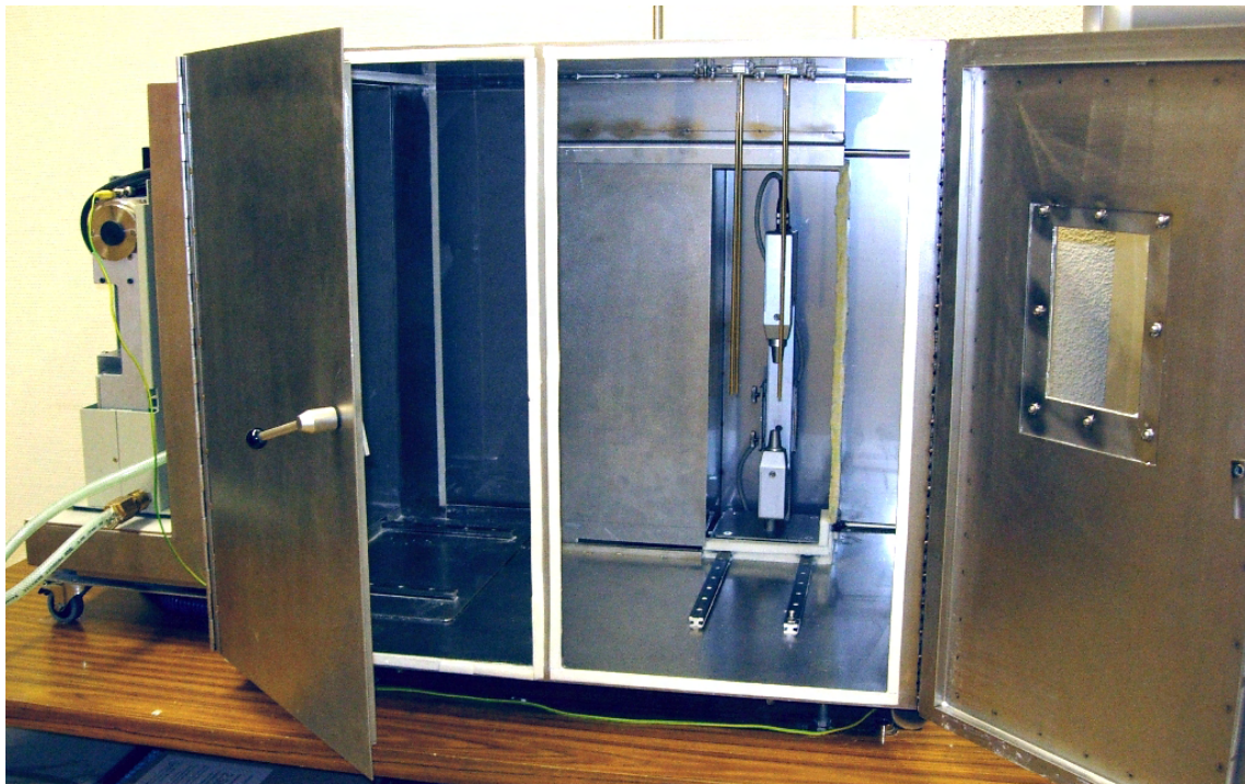
Abbildung 3.15: Die geöffnete Messkammer mit dem RBG 1000 (links im Bild). Rechts von der Mitte erkennt man die geöffnete Kammer, in der sich die Messeinheit des SKG 5 befindet.
