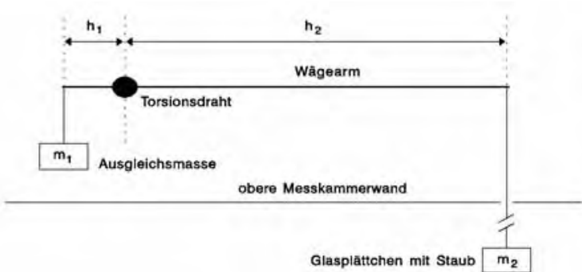
Abbildung 3.17: Skizze der Verhältnisse am Wägearm der aufzubauenden Torsionswaage. Der Torsionsdraht steht senkrecht auf der Papierebene.
