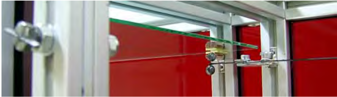
Abbildung 3.29: Das Bild zeigt den gespannten Torsionsdraht mit angebrachtem Wägearm, Ausgleichsgewichten und Spiegel.
