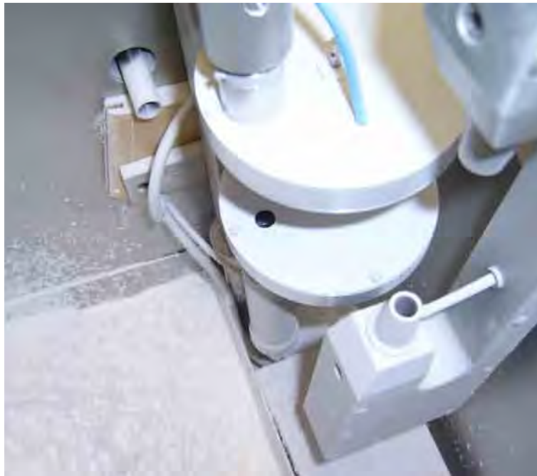
Abbildung 4.15: Messeinheiten Typ 11 und Typ 7 vertikal eingebaut in die Messkammer der Staubungsneigungsapparatur.
