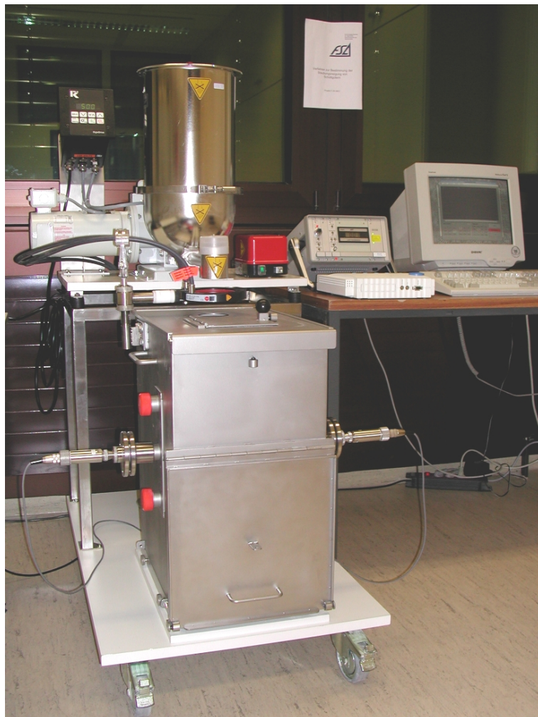
Abbildung 1.1: Apparatur zur Bestimmung der Staubungsneigung von Schüttgütern.
