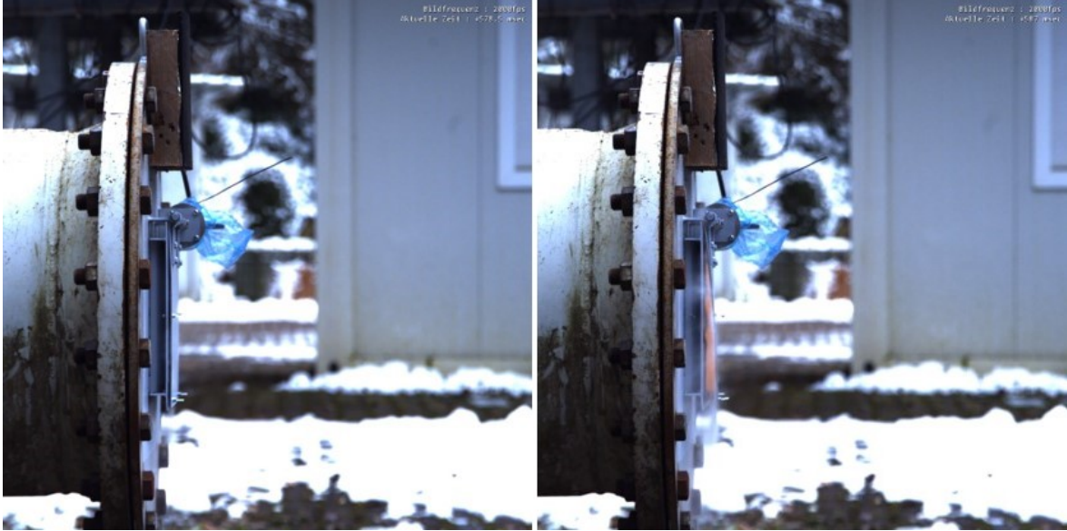
Abbildung 4.4: Zustand der Klappe bei Bestimmung von p_{\text{dyn}} mittels Hochgeschwindigkeitskamera (links), t = 0,0585 s, und Drehgeber (rechts), t = 0,067 s, Zündung bei t = 0 s.
